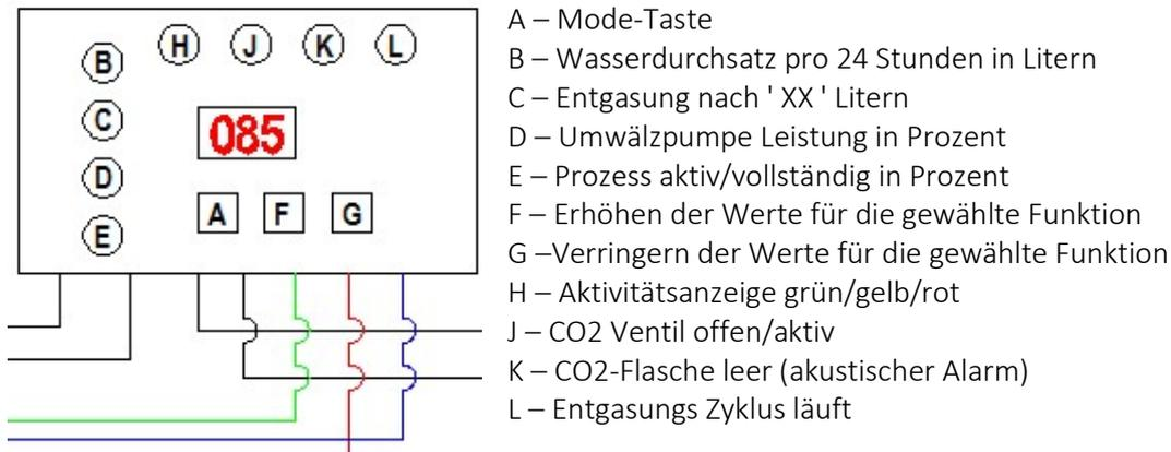
**A – Mode-Taste:** Durch Drücken der Taste werden die verschiedenen Funktionen ausgewählt.
