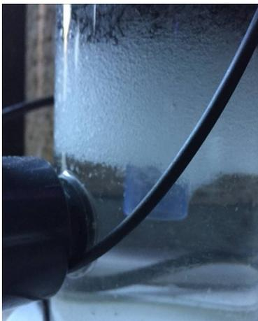
Für den optimalen Betrieb sollte die Umwälzpumpe so eingestellt werden, dass die feinen Bläschen in der Verrieselungskammer bis zu der unteren Halteplatte gehen.
