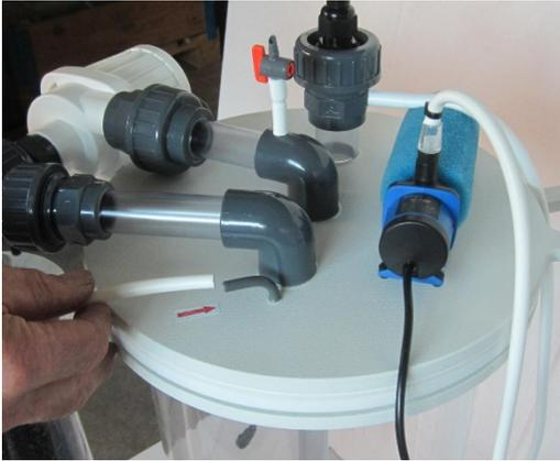
Schließen Sie den weißen Pumpenschlauch an den Zulauf auf der Oberseite des Reaktors an (siehe Abbildung links).
